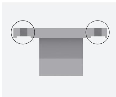
Apretar y aflojar tuercas y pernos puede causar desgaste y daños (remecanizado) a la superficie de las arandelas.
