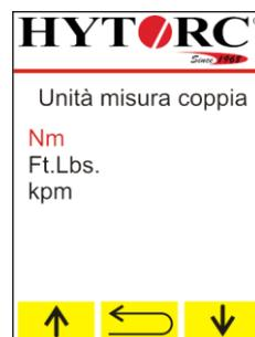
Dopo l'impostazione dell'unità per il valore della coppia, sul display viene visualizzata la scelta per l'unità della pressione.
