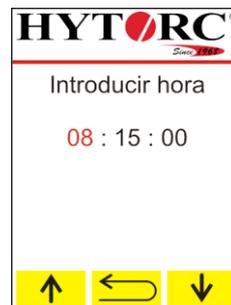
Tras el ajuste de la hora, en la pantalla se muestra la selección de la Unidad par de torsión.
