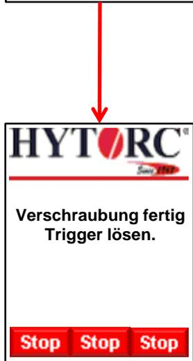
41) Der **Trigger** ist gedrückt, die Kontrollhübe wurden erfolgreich beendet und ein akustisches Signal ertönt. Bitte lösen Sie den **Trigger**.
