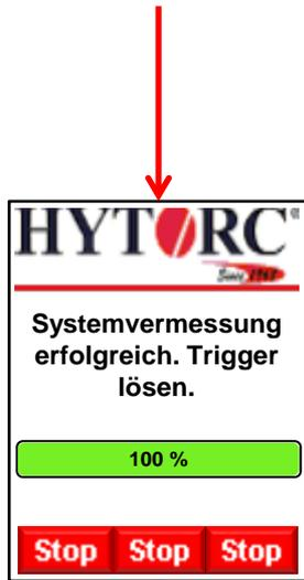
35) Die Systemvermessung wurde erfolgreich beendet und ein akustisches Signal ertönt. Bitte lösen Sie den **Trigger**.
