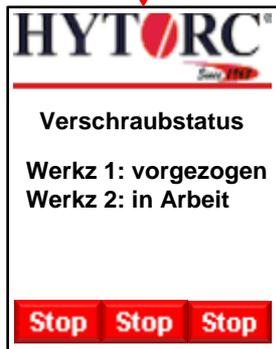
38) Der **Trigger** ist gedrückt, das Aggregat startet den vollautomatischen Verschraubprozess und der aktuelle Zustand jeder Schraube wird im Display angezeigt. Für den Fall, dass mit mehr als einem Werkzeug gearbeitet wird, zieht das Aggregat die Schrauben auf ein niedriges Drehmoment, abhängig von Werkzeugtyp und Größe, vor. Bitte halten Sie den **Trigger** gedrückt.
