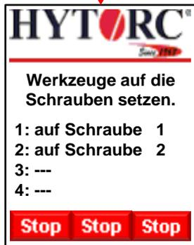
36) Nun ist das Aggregat einsatzbereit. Setzen Sie die Werkzeuge auf die Schrauben. (Darstellungsbeispiel für einen Schraubauftrag mit zwei Werkzeugen)
