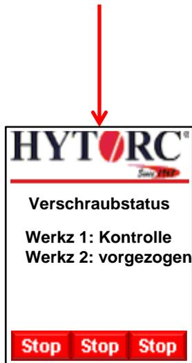
40) Der **Trigger** ist gedrückt, eine Schraube ist festgezogen und wird mit “Kontrolle” markiert. Sobald alle Schrauben festgezogen sind, beginnt das Aggregat mit der Durchführung der Kontrollhübe.
