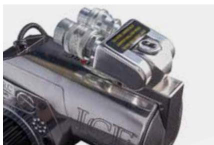
ICE è l'unico sistema di bullonatura idraulica al mondo che permette il posizionamento rapido e flessibile senza i vincoli normalmente associati ai tubi flessibili idraulici.
