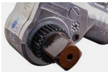
ICE è in grado di effettuare il rilascio automaticamente quando è bloccata su un bullone. Questo riduce le interruzioni non programmate nel processo di bullonatura.
