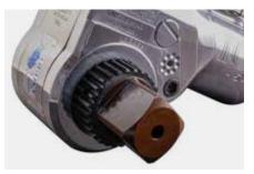
A ICE tem capacidade de desbloqueio automático quando travada em um parafuso. Isso reduz as interrupções não planejadas no processo de aparafusamento.
