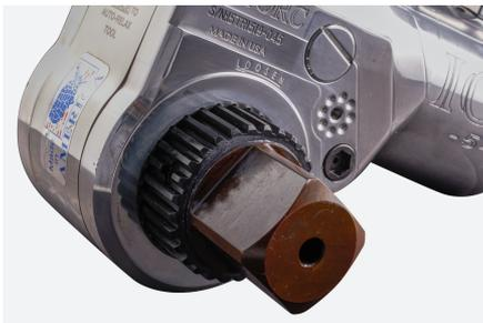
La ICE puede liberarse automáticamente cuando se encuentra bloqueada en un perno. Esto reduce las interrupciones no planificadas en el proceso de empernado.
