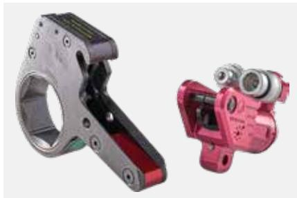
XLCT系列采用防滑棘轮，可实现更强劲的突破和更快的紧固。工具内的辅助棘爪防止棘轮与其被驱动的方向相反地转动。
