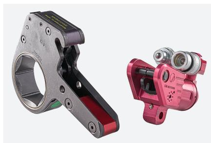
La série XLCT est dotée d'un cliquet antidérapant pour une force plus importante et un serrage plus rapide. Le second cliquet à l'intérieur de l'outil empêche le premier de tourner dans le sens opposé à celui dans lequel il est entraîné.
