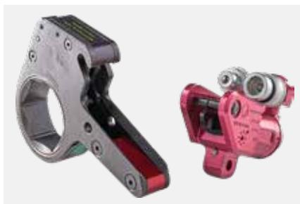
La serie XLCT presenta un cricchetto non scorrevole per uno svitamento più efficace e un serraggio più veloce. Il dente di arresto secondario all'interno dello strumento evita che il cricchetto ruoti dalla parte opposta alla direzione in cui viene azionato.
