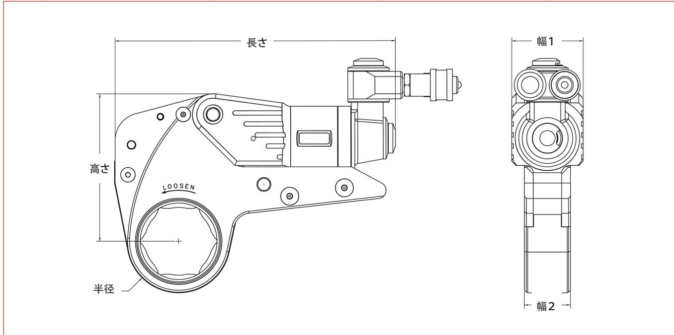
記録: H = 高さ W1 = パワーヘッドの幅 W2 = リンクの幅 L = 長さ R = 半径
