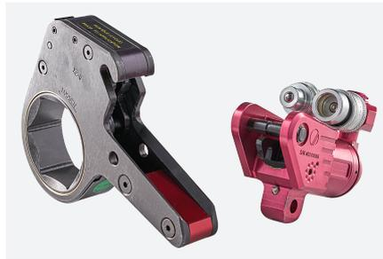
XLCTシリーズは、より強力なブレークアウトとより速い締め付けのためのゼロスリップラチェットを備えています。ツール内の二次爪は、ラチェットが駆動されている方向と反対方向に回転するのを防止します。
