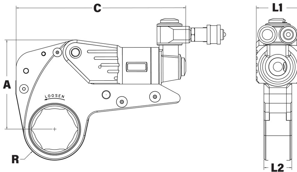
LEGENDA: A = ALTURA L1 = LARGURA DO CABEÇOTE DE ACIONAMENTO L2 = LARGURA DA LIGAÇÃO C = COMPRIMENTO R = RAIOS
