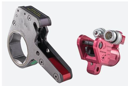
A série XLCT contém uma engrenagem com trava antirretorno para quebra de torque mais potente e aperto mais rápido. A lingueta secundária dentro da ferramenta impede que a chave catraca gire para o lado oposto da direção em que está sendo conduzida.
