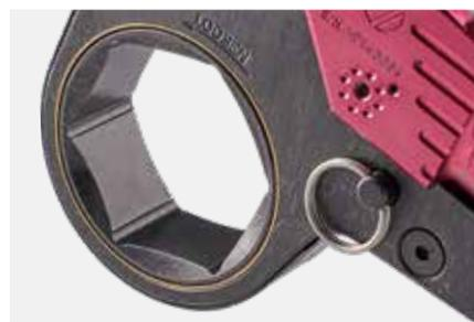
Серия XLCT поставляется со сменными картриджами для работы с 6-точечными шестигранными, 12-точечными шестигранными, с универсальными приводами, с квадратными приводами, с открытыми гаечными ключами и многими другими конфигурациями, что значительно упрощает даже самые сложные задачи, связанные с применением болтовых соединений.
