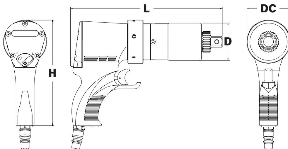
图例：H = 高度 L = 长度 D = 变速箱外径 DC = 轴环直径
