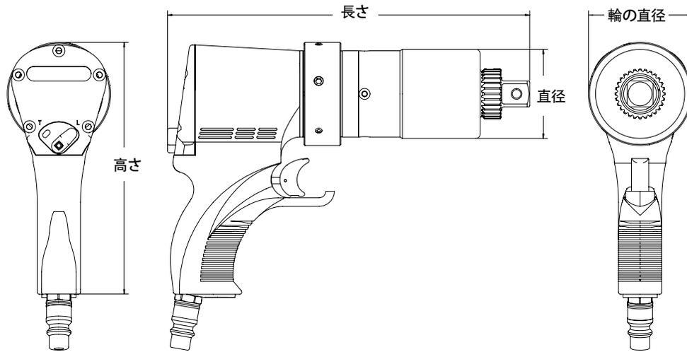
記録: H = 高さ L = 長さ D = 直径 ギアボックスの外径 DC = 輪の直径
