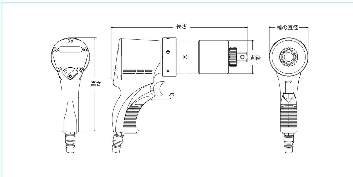
記録: H = 高さ L = 長さ D = 直径 ギアボックスの外径 DC = 輪の直径
