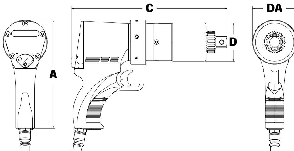
LEGENDA: A = ALTURA C = COMPRIMENTO D = DIÂMETRO EXTERNO DA CAIXA DE ENGRENAGENS DA = DIÂMETRO DO ANEL
