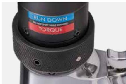
Простой поворот переключателя переводит инструмент из высокоскоростного режима в режим максимальной производительности с регулируемым крутящим моментом, что облегчает выбор нужного уровня мощности.
