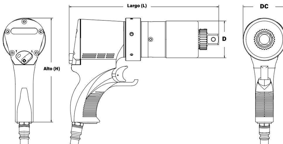
LEYENDA: H = ALTURA L = LARGO D = DIÁMETRO EXTERIOR DE LA CAJA DE ENGRANES DC = DIÁMETRO DEL COLLAR
