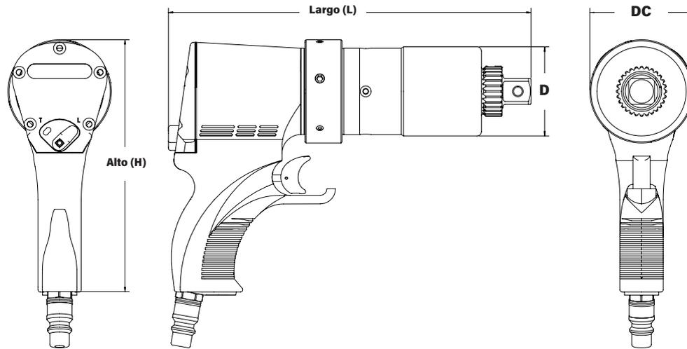
LEYENDA: H = ALTURA L = LARGO D = DIÁMETRO EXTERIOR DE LA CAJA DE ENGRANES DC = DIÁMETRO DEL COLLAR
