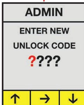
Pour enregistrer les données, l'utilisateur doit d'abord saisir le CODE DE DÉVERROUILLAGE (UNLOCK CODE) à 4 chiffres pour déverrouiller l'outil. Pour saisir le code, ↑ appuyez sur le bouton pour augmenter le chiffre ou ↓ pour diminuer le chiffre, appuyez → sur pour avancer au chiffre suivant jusqu'à ce que le code correct soit saisi (par défaut 0000). Lorsque le code correct à 4 chiffres est saisi, appuyez de nouveau sur → pour passer au MODE SÉLECTION DE MISSION.
