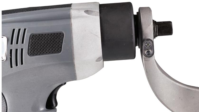
Maintenez le bouton localisé sur le bras de réaction tout en le faisant glisser sur la section cannelée en passant devant l'embout d'entraînement carré et relâchez le bouton une fois que le bras est bien en place. Testez la connexion en essayant de tirer le bras, sans appuyer sur le bouton de déverrouillage.
