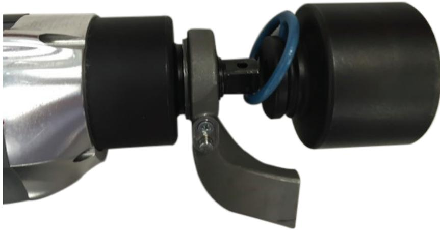
Asegure la conexión usando un pasador de bloqueo a través de la guía cuadrada y un anillo de retención.
