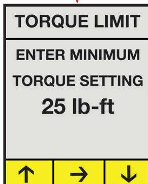
Para ajustar el límite mínimo de PAR presione ↑ para aumentar el valor o ↓ para disminuir el valor.
