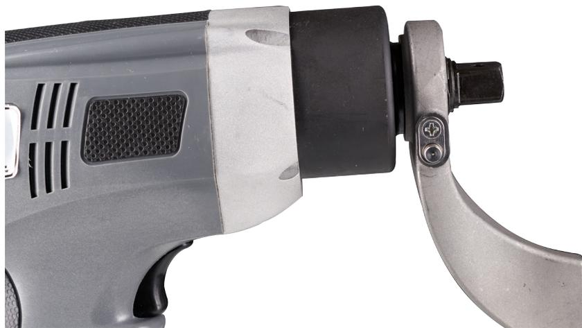
Tenere premuto il pulsante sul braccio di reazione mentre lo si fa scorrere nella sezione scanalata oltre l'attacco quadro e rilasciare il pulsante una volta che il braccio è completamente innestato. Testare il collegamento tentando di estrarre il braccio senza premere il pulsante di rilascio.
