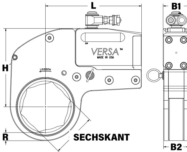
LEGENDE: H = HÖHE B1 = BREITE DES ANTRIEBSKOPFES B2 = BREITE DER VERBINDUNG L = LÄNGE R = ENTFERNUNG VON DER SECHSKANT-ECKE
