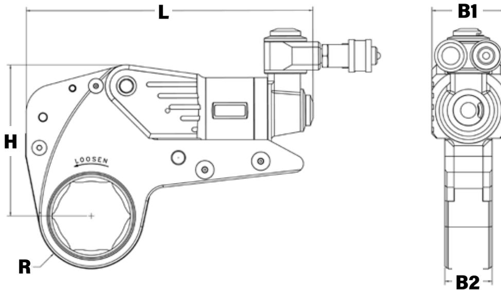
LEGENDE: H = HÖHE B1 = BREITE DES POWERKOPFES B2 = BREITE DER VERBINDUNG L = LÄNGE R = RADIUS
