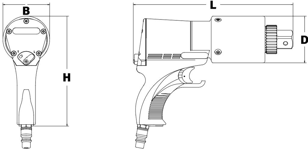
LEGENDE: H = HÖHE B = BREITE L = LÄNGE D = AUSSENDURCHMESSER DES GETRIEBES
