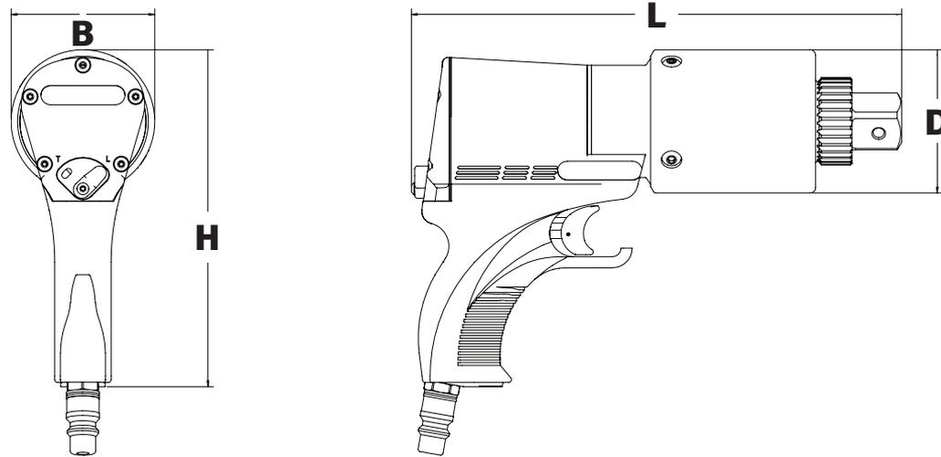
LEGENDE: H = HÖHE B = BREITE L = LÄNGE D = AUSSENDURCHMESSER DES GETRIEBES
