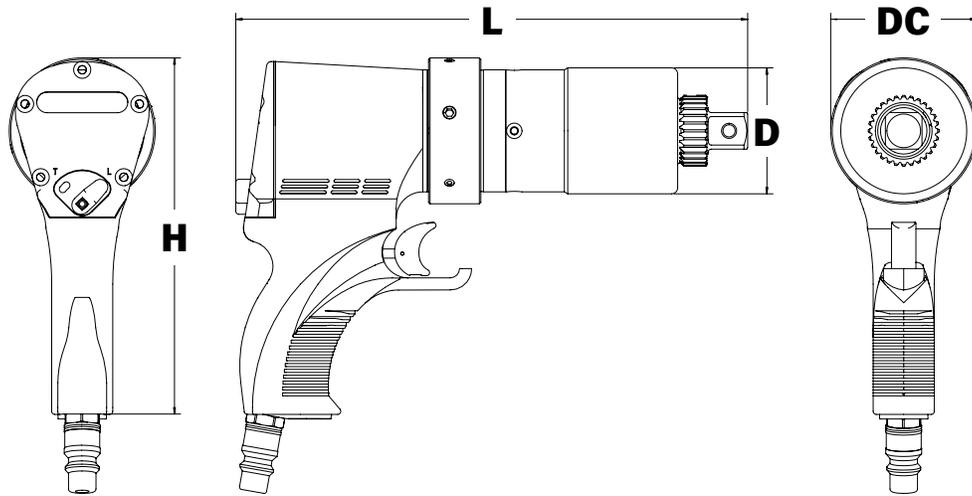
LEGENDE: H = HÖHE L = LÄNGE D = AUSSENDURCHMESSER DES GETRIEBES DM = DURCHMESSER MANSCHETTE
