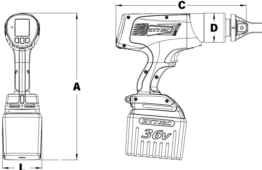
LEGENDA: A = ALTURA L = LARGURA C = COMPRIMENTO D = DIÂMETRO
