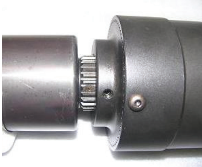
Figura 17 - Instalación del tornillo empotrado en HYTORC Washer Driver.
