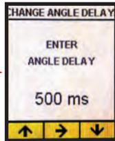
**SET ANGLE DELAY(각도 지연 설정):** 건이 토크에 도달하는 시간과 지정된 각도로 돌리기 시작하는 시간 사이의 시간 지연을 조정할 수 있습니다. 이 시간 동안 공구는 토크(Torque) 작업과 각도(Angle) 동작 사이에서 일시 중지합니다.
