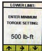
**LOWER TORQUE LIMIT(토크 하한):** 기본 잠금 해제 코드(Unlock Code)는 0입니다(잠금 해제 코드를 변경하려면 26 페이지의 "잠금 해제 코드 변경"을 참조하십시오).
