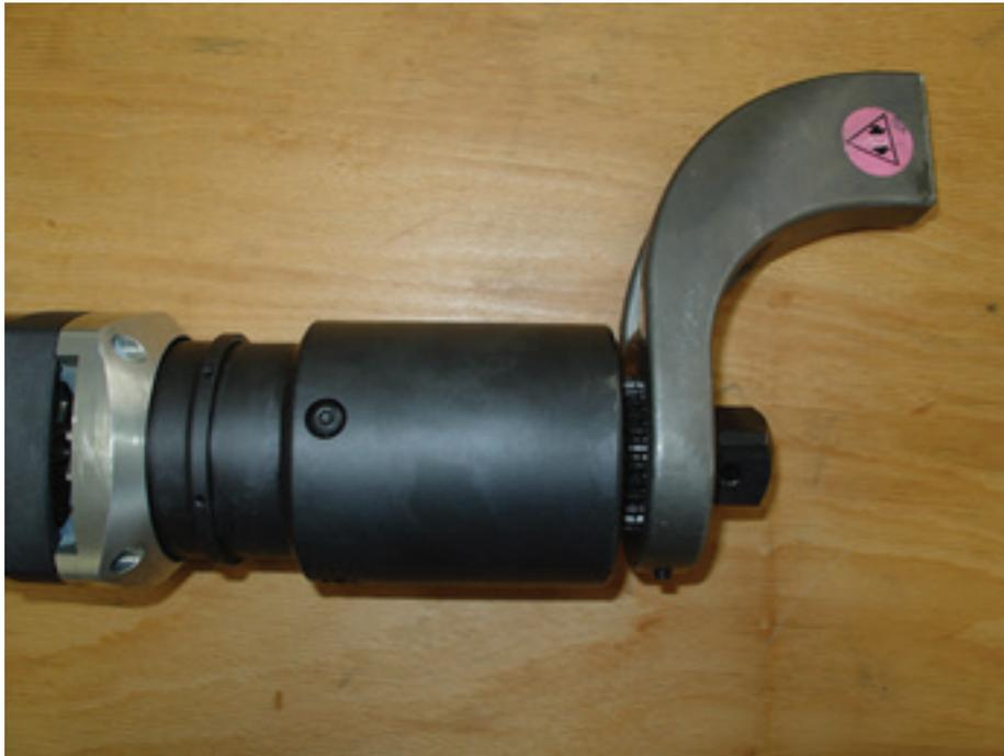
Befestigen Sie die Drehmomentstütze so auf dem LITHIUM, dass die Befestigungsschraube mit der Ausparung mit den Zähnen übereinstimmt; ziehen Sie diese fest und lösen sie dann um eine 1/4 Umdrehung.
