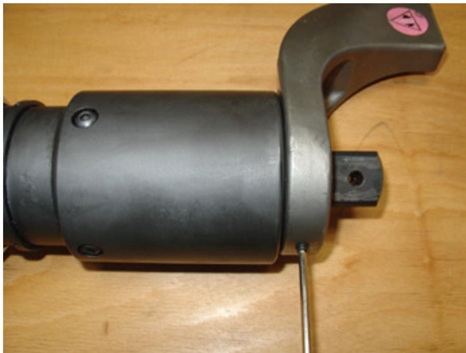
Abbildung 7 - Stecknussaufsatz
