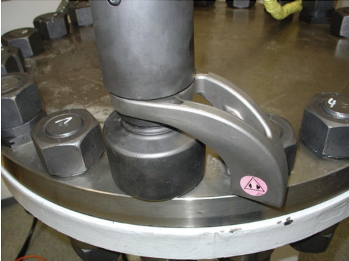
Die Nutzung der Unterlegscheibe HYTORC Washer macht die Verwendung externer Drehmomentstützen überflüssig und trägt somit zu einer erhöhten Sicherheit des Bedieners bei. (Siehe Abschnitt "Übersicht HYTORC Washer")
