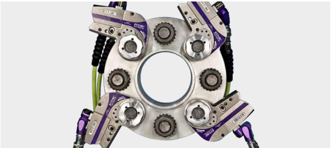
El sistema de empernado hidráulico de múltiples herramientas Simultorc de HYTORC asegura el cierre de juntas paralelas, mejora la seguridad y reduce el tiempo de empernado hasta en un 50 % o más. Mediante el uso de múltiples herramientas en una sola brida, el torque se puede aplicar de manera simultánea con un solo botón. Al combinar Simultorc con una solución de empernado sin brazos de reacción de HYTORC se maximiza la seguridad, la productividad y la calidad del trabajo.
