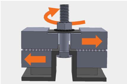
볼트 너트는 진동으로 인한 표면간 상대운동으로 풀려질 수 있습니다. J-Washer의 웅이진 면은 토크가 적용될 때 너트를 잠가서 풀림현상이 일어나지 않습니다. 이러한 풀림방지 기능은 산업표준인 풀림을 야기하는 동하중 모의실험, 웅커테스트를 통해 입증되었습니다.
