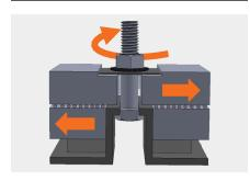
볼트 너트는 진동으로 인한 표면간 상대운동으로 풀려질 수 있습니다. J-Washer의 옹이진 면은 토크가 적용될 때 너트를 잠가서 풀림현상이 일어나지 않습니다. 이러한 풀림방지 기능은 산업표준인 풀림을 야기하는 동하중 모의실험, 융커테스트를 통해 입증되었습니다.
