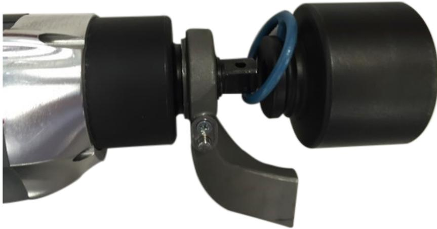
Prenda o soquete passando um pino de travamento através do acionamento quadrado e um anel de retenção.
