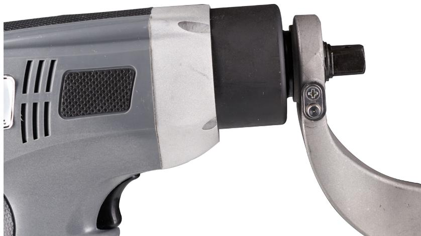
Segure o botão do braço de reação enquanto o desliza sobre o tambor ranhurado após passar pelo acionamento quadrado. Solte o botão quando o braço estiver totalmente encaixado. Teste o encaixe, tentando puxar o braço sem pressionar o botão de liberação.
