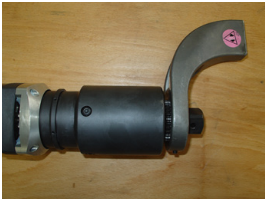
Figura 5 - Fixação do braço de reação
