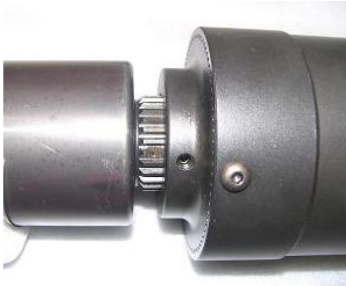
Figura 17 - Instalando o parafuso de fixação na unidade de acionamento da HYTORC Washer™
