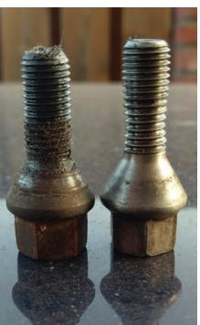
Il design del filetto rivestito del dado anti-usura HYTORC elimina la corrosione microscopica del materiale che si verifica quando i fissaggi sono sottoposti a temperature elevate e a un aumento dell'attrito per periodi di tempo prolungati. Questa tecnologia contrasta l'effetto di sfaldatura della deformazione plastica e del trasferimento di materiale in microscala delle superfici dei filetti.
