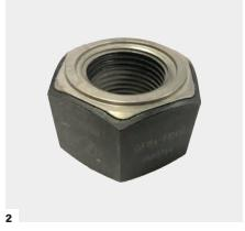
Il dado anti-usura HYTORC viene installato con la superficie di supporto del carico (1) rivolta verso la flangia. L'anello indicatore del lato superiore (2) aiuta a garantire che il dado venga installato correttamente.
