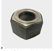
La tuerca HYTORC sin desgaste se instala con la superficie de carga (1) orientada hacia la brida. El anillo indicador del lado superior (2) ayuda a asegurar que la tuerca esté instalada correctamente.
