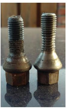
El diseño de rosca recubierta de la tuerca HYTORC sin desgaste elimina la corrosión del material microscópico que ocurre cuando los pernos están expuestos a altas temperaturas y a una mayor fricción durante períodos de tiempo prolongados. Esta tecnología contrarresta el efecto desgastante de la deformación plástica y la transferencia de material microscópico de las superficies de la rosca.
