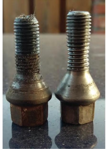
Das beschichtete Gewindedesign der HYTORC Gall-Free Nut eliminiert die mikroskopische Materialkorrosion, die auftritt, wenn Verbindungselemente hohen Temperaturen und erhöhter Reibung über längere Zeiträume ausgesetzt sind. Diese Technologie wirkt dem Kaltschweißeffekt der plastischen Verformung und des mikroskaligen Materialübertrags an Gewindeoberflächen entgegen.
