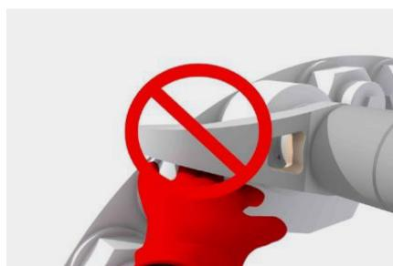
J-垫圈提供外部反作用凸耳与套筒驱动器或反作用板安全接合以在扭矩操作过程中支撑反作用力。与标准的HYTORC反作用垫圈一致, 新型J-垫圈消除了对单独的反作用力臂的需求, 消除了夹点并大大降低了手受伤的风险。
