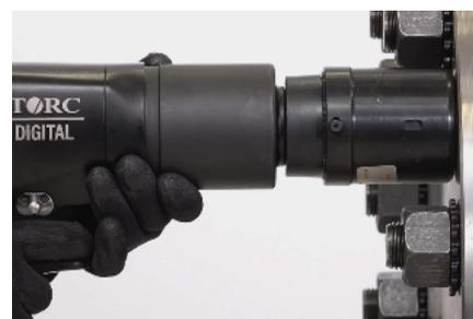
J-垫圈的独特设计可在拧紧期间锁定紧固件组件。当与HYTORC扭矩工具结合使用时, J-垫圈可提供无与伦比的螺栓连接效率, 并减少了工作时间。
