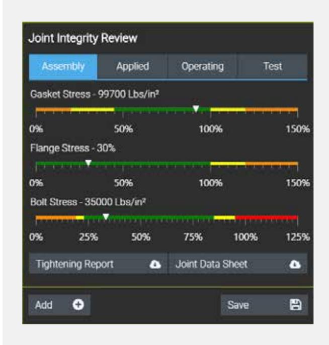
L'inspection de l'intégrité des joints donne des indications simples et claires des niveaux de contraintes de tous les composants pendant l'assemblage et les opérations. Les avertissements mécaniques fournissent des conseils en temps réel sur l'intégrité des joints. Ils permettent de réduire considérablement le risque de fuite d'hydrocarbures ou d'endommager les composants de la bride au fil du temps.
