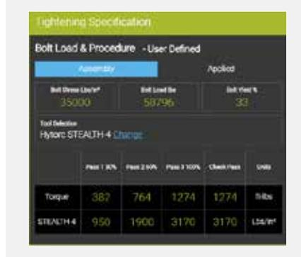
Calcul instantané des exigences de charge du boulon, des réglages recommandés de chacun des outils et affichage du schéma de serrage.
