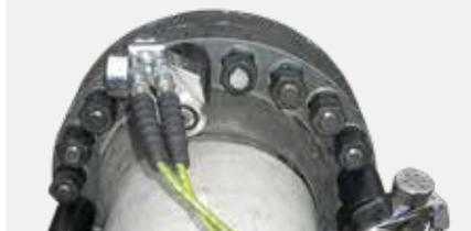
HYTORC commence à équiper toutes ses pompes hydrauliques de quatre ports et à promouvoir l'utilisation simultanée de plusieurs outils, Simultorc, pour obtenir une charge de boulon régulière et précise ainsi que réduire le temps de serrage.
