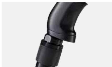
Le jGun DIGITAL est le premier du genre avec un régulateur d'air intégré pour un réglage simple du couple en faisant tourner le connecteur au bas de la poignée. Particulièrement pratique pour passer du serrage au desserrage, vous pouvez donc aisément passer à la puissance maximale pour un démontage rapide et facile.
