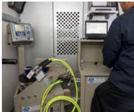
Notre laboratoire mobile permet l'étalonnage sur site des clés dynamométriques manuelles, des outils hydrauliques, pneumatiques et électriques avec un couple de sortie pouvant atteindre 20 000 pieds-livres. Pour étalonner de plus gros outils, nos techniciens de maintenance proposent des services d'enlèvement et de livraison.
