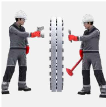
Quetschrisiken und mehr Personal; schädigende Querkräfte; Biegekräfte; kürzere Lebensdauer von Schrauben und Muttern.
