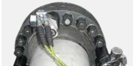
HYTORC beginnt, alle Hydraulikpumpen mit vier Anschlüssen auszustatten und den gleichzeitigen Einsatz mehrerer Werkzeuge voranzutreiben. Dies wird Simultorc genannt und soll eine gleichmäßige und exakte Bolzenlast mit verkürzter Verschraubungszeit erreichen.
