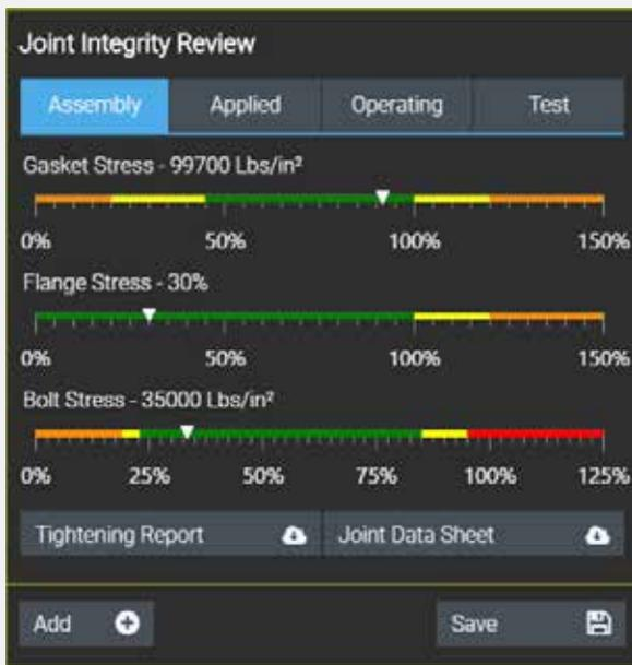
Ein einzigartiger Joint Integrity Review gibt eine einfache und deutliche Indikation der Stressbelastung für alle Komponenten während der Montage und in Betrieb. Technische Warnungen geben sofortigen Hinweis bezüglich der Integrität der Verbindung. Verringern Sie über die Zeit erheblich das Risiko von Kohlenwasserstoff-Leckage und Schäden an den Flansch-Bauteilen.
