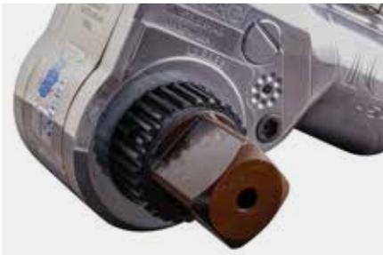
Der ICE kann sich automatisch selbst entriegeln, wenn er an einem Bolzen arretiert ist. Dies reduziert ungeplante Unterbrechungen beim Verschraubungsprozess.
