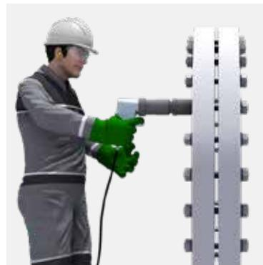
Keine Quetschrisiken; intuitive Bedienung; weniger Personal; keine schädigenden Querkräfte oder Biegekräfte; Schrauben und Muttern können wiederverwendet werden.
