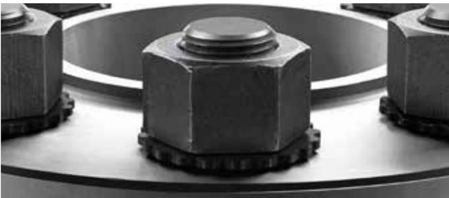
Die HYTORC-Unterlegscheibe macht Drehmomentstützen überflüssig, welche die häufigste Ursache von Verletzungen bei Verschraubungsprojekten sind. Das einzigartige Design der Unterlegscheibe ermöglicht es der doppelschichtigen Sicherheits-Stecknuss beim Drehen der Mutter, an der Unterlegscheibe selbst entgegenzuwirken.
