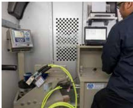
Unser mobiles Kalibrierlabor bietet eine Vor-Ort-Kalibrierung manueller Drehmomentschrauber sowie hydraulischer, pneumatischer und elektrischer Werkzeuge mit einem Ausgangsdrehmoment von bis zu 20.000 ft.-lbs. Für die Kalibrierung von größeren Werkzeugen bieten unsere Service-Techniker einen Hol- und Bringe-Service.
