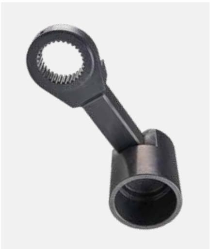
Controle la carga del perno y mejore la seguridad con la función de empernado de doble reacción del soporte para cables de aerogeneradores. Este accesorio disminuye la fuerza de carga lateral, aumenta la vida útil de las herramientas de torque y elimina las rayaduras y abolladuras de la arandela y de las tuercas adyacentes, causadas por los brazos de reacción tradicionales.
