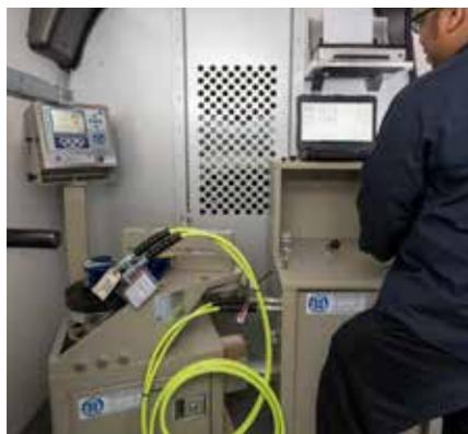
Nuestro laboratorio de calibración móvil proporciona calibración en el lugar de las herramientas de torque hidráulicas, neumáticas y eléctricas, con una salida de torque de 20 000 ft.-lb. Para calibrar herramientas más grandes, nuestros técnicos de mantenimiento le ofrecen un servicio de recogida y entrega de herramientas.
