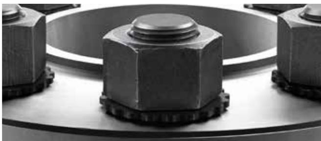
La arandela HYTORC elimina la necesidad de brazos de reacción, que son la causa más común de daños durante los trabajos de empernado. El diseño único de la arandela permite que los dados de seguridad de dos capas reaccionen sobre la arandela misma, mientras se gira la tuerca.
