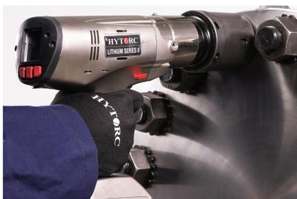
Un sistema di misurazione diretta della coppia che utilizza un trasduttore basato sulla deformazione in un sistema di monitoraggio a circuito chiuso fornisce una coppia più ripetibile e consente caratteristiche di bullonatura avanzate.
