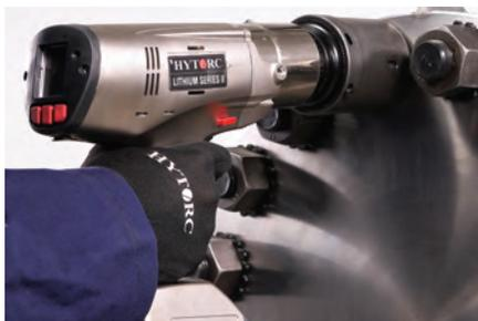
閉ループ監視システムでひずみベースのトランスデューサを利用する直接トルク測定システムは、より再現性の高いトルクを提供し、高度なボルト締め機能を可能にします。
