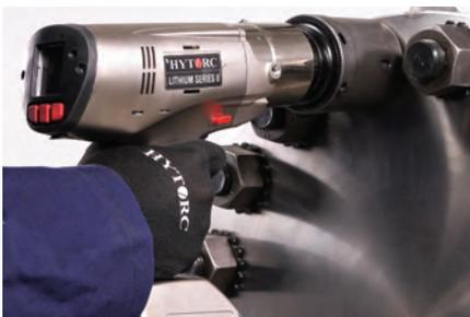
Um sistema de medição de torque direto que utiliza um extensômetro em monitoramento de ciclo fechado para entregar torques mais repetíveis e permitir recursos de aparafusamento avançado.
