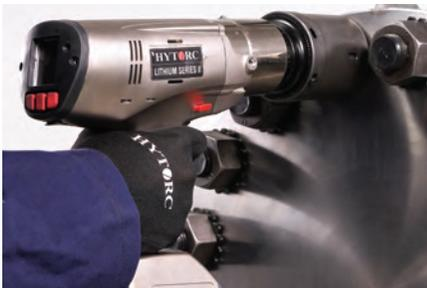
Un sistema directo de medición de torque que utiliza un transductor de tensión en un sistema de monitoreo de circuito cerrado, proporciona un torque más repetible y permite funciones avanzadas de empernado.
