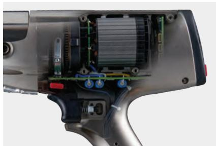
La herramienta utiliza un novedoso motor sin escobillas de 36 V CC que funciona más silenciosamente, levanta menos temperatura y tiene una vida útil significativamente más larga.
