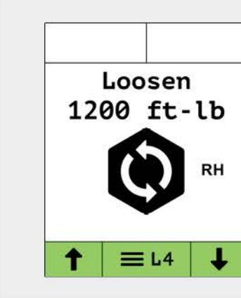
本例显示的是用右手 (RH) 紧固时的方向改变。方向开关会根据左手紧固、HYTORC 垫圈和 HYTORC 螺母的需要自动设置合适的方向。
