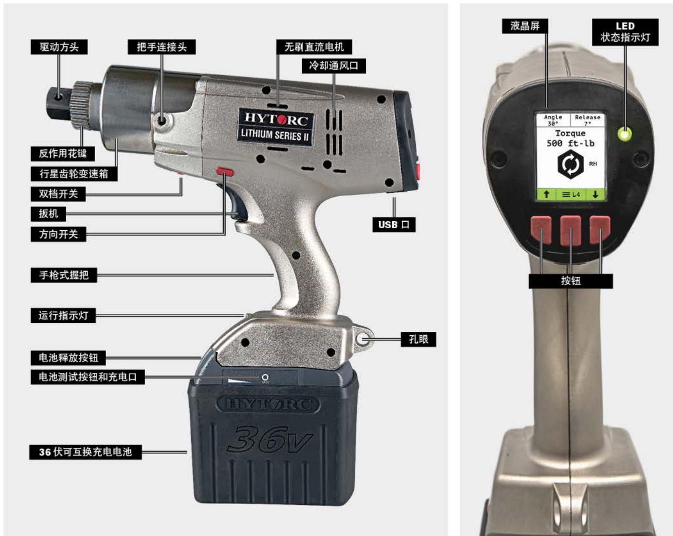
LITHIUM SERIES® II 工具是新一代电动扭力工具，在前代产品基础上有了重大改进，提高了耐用性，扩展了功能，并且使用更加直观简便。其新型 36 伏无刷直流电机的使用寿命比前代产品延长了 5 倍以上。该工具采用 TorcSense™ 技术，可直接测量扭矩，从而提高了结果的可重复性。由于采用了蓝牙无线技术标准，使数据采集和固件升级变得前所未有的简单。该工具采用全铝外壳封装，显著提高了工业用途下的耐用性。经过彻底重新设计的用户界面，通过高分辨率显示屏和按钮控制面板，可以直观的方式访问所有软件控制的螺栓紧固功能。该工具配备了相同的 36 伏电池系统，即使在最苛刻的作业条件下也能持续供电，输出扭矩高达 5000 英尺 - 磅。该工具可灵活支持各种配置，包括传统的套筒和反力臂、HYTORC 垫圈，以及使用 HYTORC 螺母的精密机械张紧功能。
