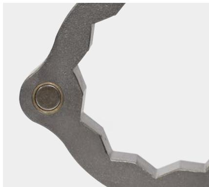
Cette Clé de Soutien est équipée de deux aimants de grande puissance encastrés sur la face de l'outil en contact avec l'unité. Ces aimants permettent de mettre rapidement la clé en place et de la maintenir en position contre un revêtement en acier.
